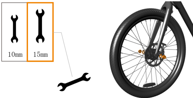
Kuva 7 – Varmista, että lukitusprikat ovat oikein päin ja kiristä mutterit
