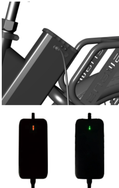
Kuva 21 - Akun lataaminen pyörän rungossa.
